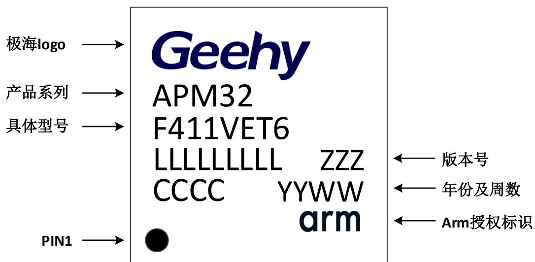
图 22 LQFP64 - 64 引脚，10 x 10mm 示意图
