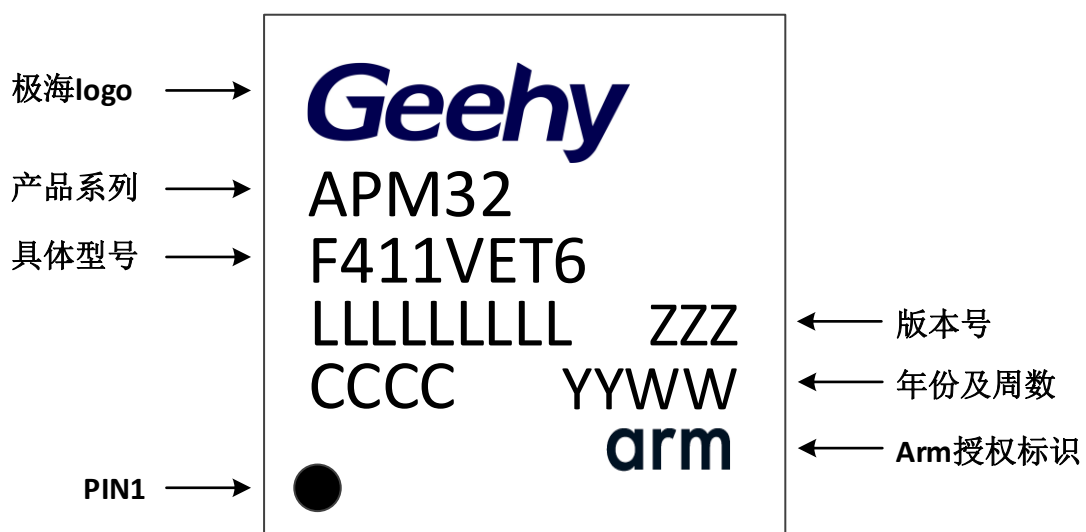
图 19 LQFP100 - 100 引脚, 14 x 14mm 示意图
