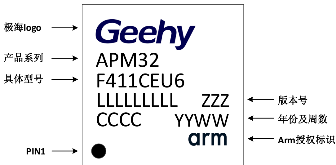
图 28 QFN448 - 48 引脚, 10 x 10mm 示意图
