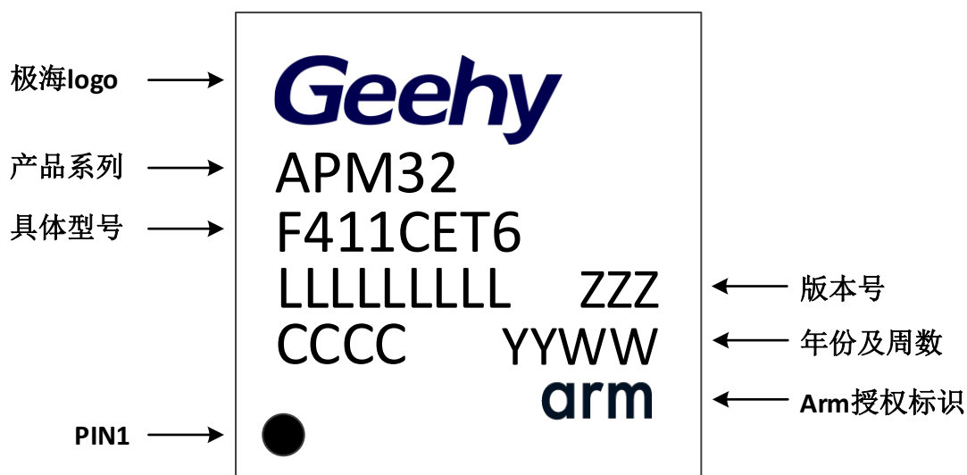
图 25 LQFP48 - 48 引脚，10 x 10mm 示意图
